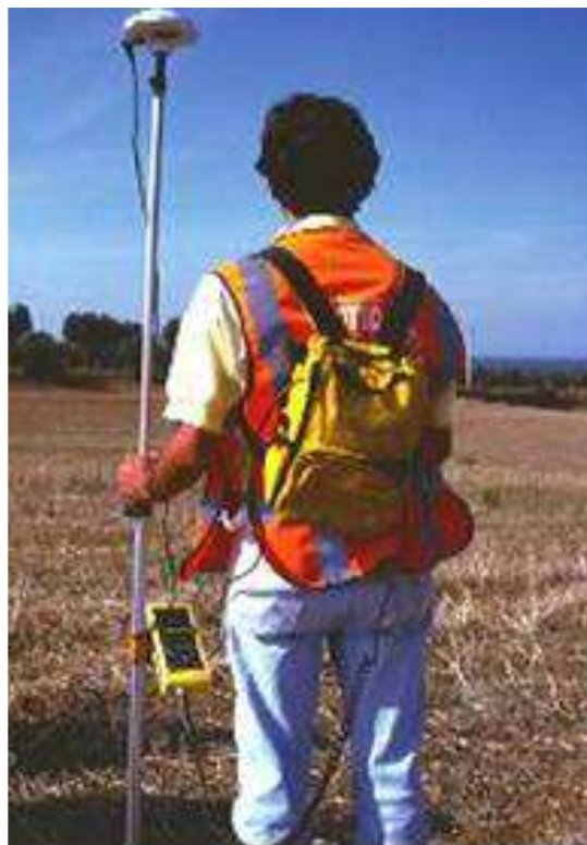
Figura 2.9 - Rilievo topografico mediante uso di GPS
