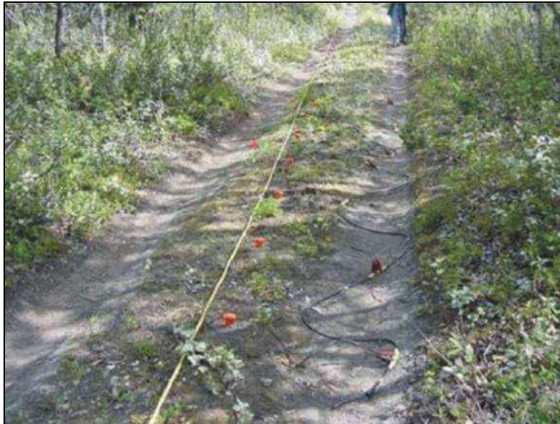
Figura 2.15 - Esempio di stendimento geofoni su strada sterrata
