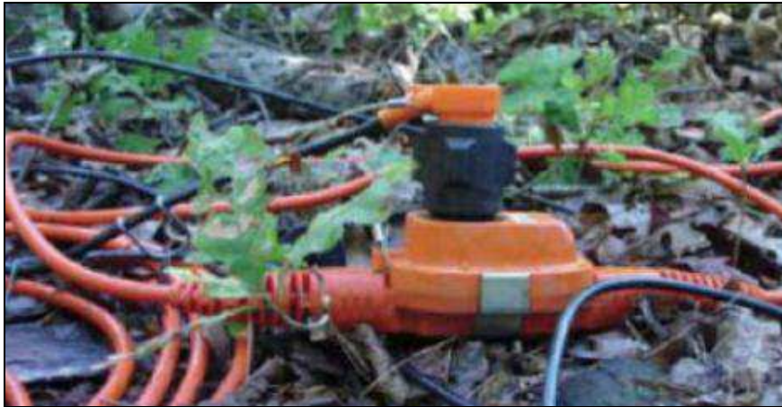
Figura 2.7 - Posizionamento dei geofoni
