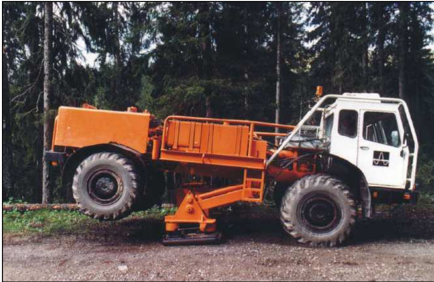
Figura 2.18 - Esempio di vibratore predisposto per l'energizzazione del terreno
