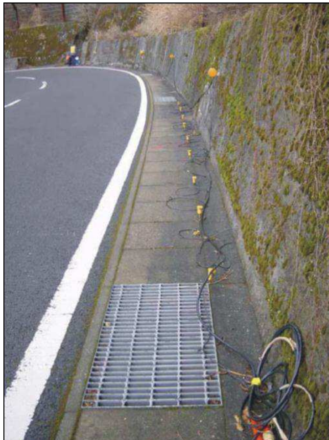
Figura 2.14 - Esempio di stendimento geofoni su strada
