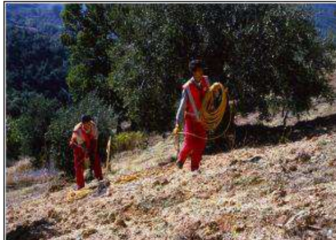
Figura 2.12 - Stesura dei cavi, dei geofoni e della strumentazione
